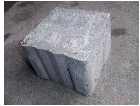
Abbildung 5: Der Betonstein Via Castello hat an den Seiten großflächige Abstandsblöcke, die von kleinen senkrechten Rillen unterbrochen sind
